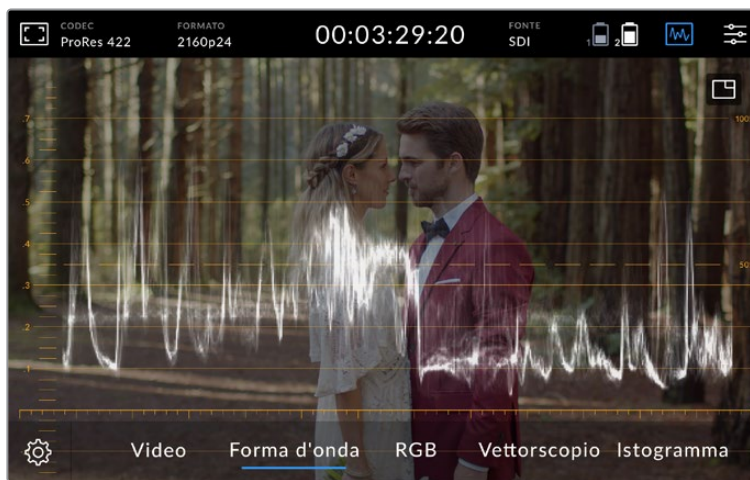
La forma d'onda mostra i valori di luminanza
