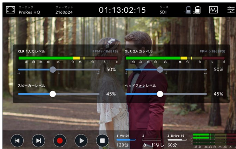
7インチモデルのVideo AssistではXLRオーディオレベルも調整可能
