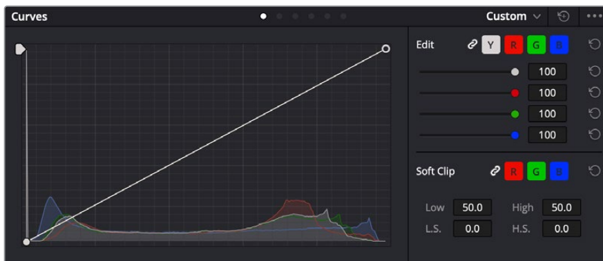
커브 팔레트는 프라이머리 색보정에 쓰이는 색보정 도구로, 파워 윈도우를 사용할 때 클립에서 특정 영역의 색상을 향상시키는데 사용합니다.
